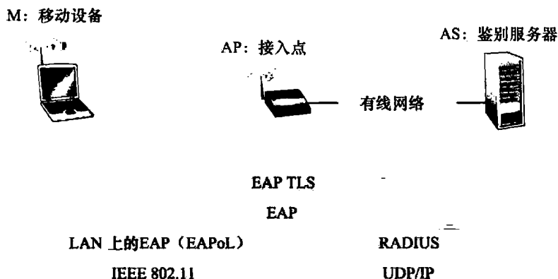
图 8-32 EAP 是一个端到端协议。EAP 报文使用 EAPoL 封装，运行在移动设备和接入点之间的无线链路之上，并在接入点和鉴别服务器之间使用 UDP/IP 之上的 RADIUS
